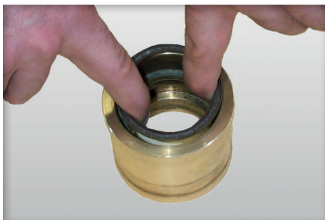
04 将密封垫圈支座组件 ( 18 ) 置于干净平面上并取出密封垫圈。
