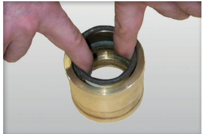
04 Positionner le groupe support des garnitures sur un plan propre et dégager les garnitures (pos. 16).
