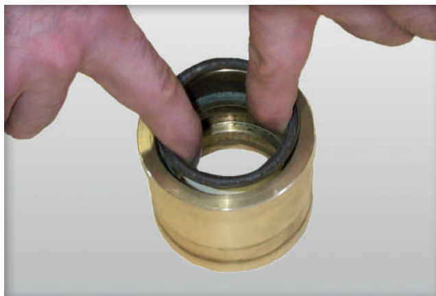
04 Posizionare il gruppo supporto guarnizioni su un piano pulito e sfilare le guarnizioni (pos. 16).
