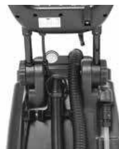
Сливной шланг для простого опорожнения системы
