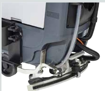
Высокая эффективность всасывания, изогнутый скребок и запатентованная система крепления лезвия
