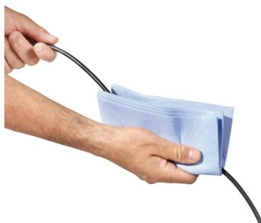
Шнур должен быть чистым, чтобы не допустить отпечатков на стенах и мебели. Чтобы уменьшить риск нанесения отпечатков и повреждений, после работы шнур следует аккуратно свернуть, начав от машины.
