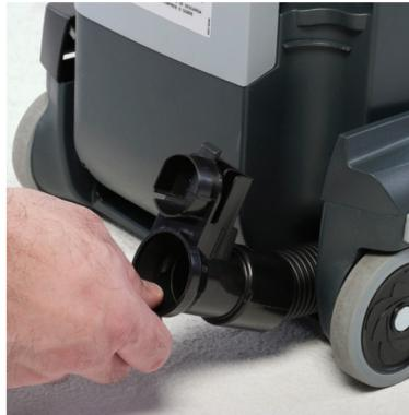
2. Проверить шланг и при необходимости удалить загрязнения ручкой щётки или подобным предметом. Также проверить насадку и трубку.
